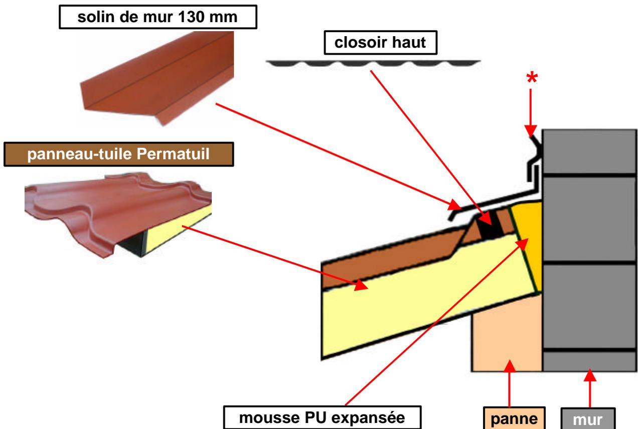
\* Pour la finition, réaliser un solin étanche adapté au revêtement du mur
