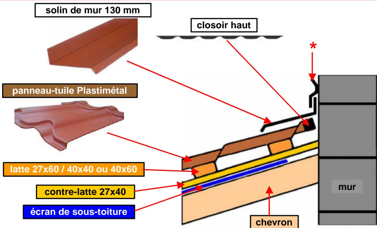
\* Pour la finition, réaliser un solin étanche adapté au revêtement du mur
