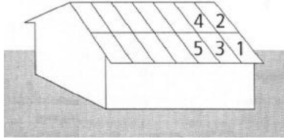
recouvrement de 200 mm
